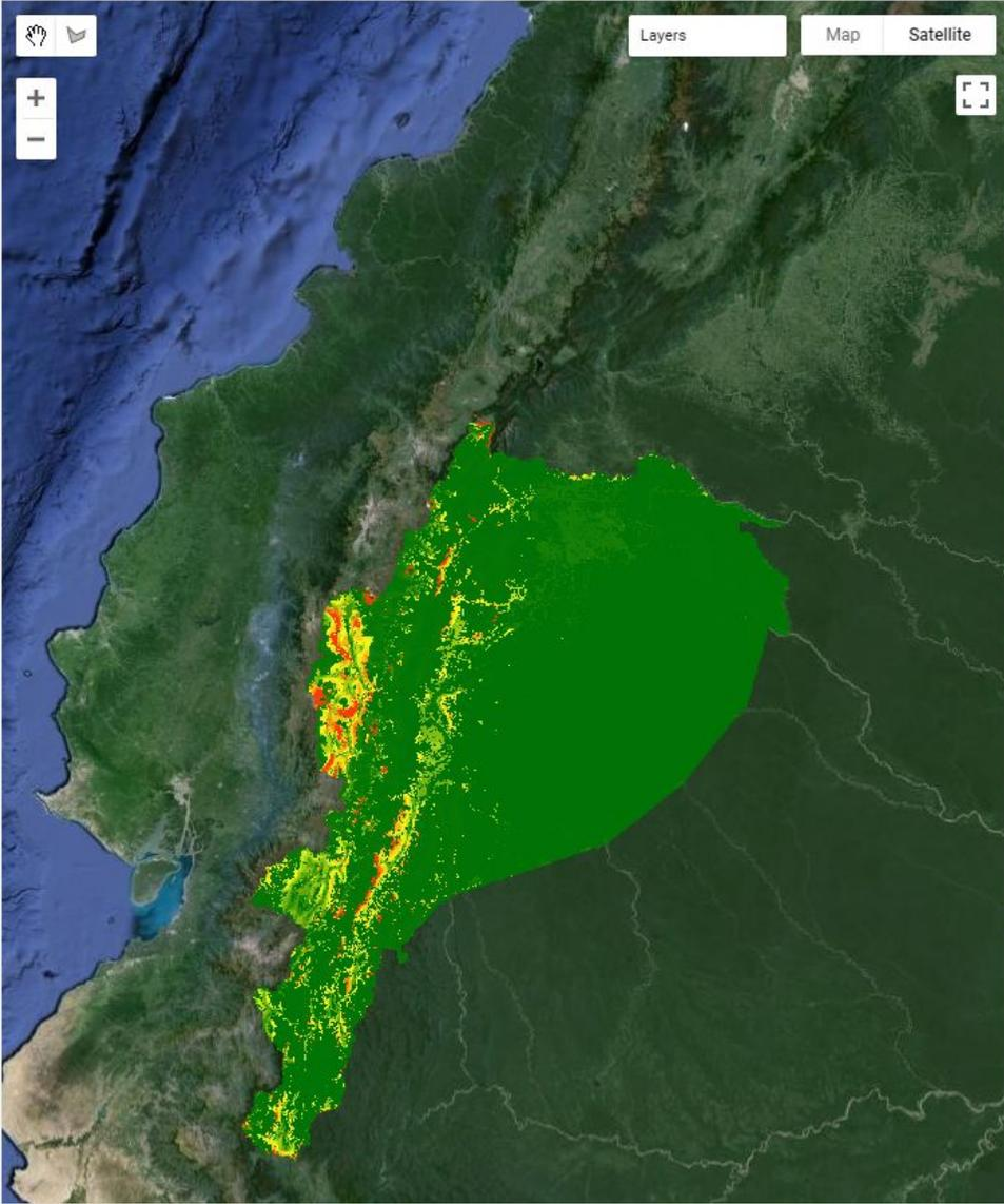
laminar aplicando la Ecuación Universal de Pérdida de Suelo Revisada (RUSLE, por sus siglas en inglés) en varios intervalos temporales y con una resolución espacial de 30 metros. Diferentes factores determinantes, como la erosividad de la lluvia (R), la erodabilidad del suelo (K), la longitud e inclinación de la pendiente, la cobertura y uso del suelo (C) y las prácticas de manejo (P) también son modelados.
